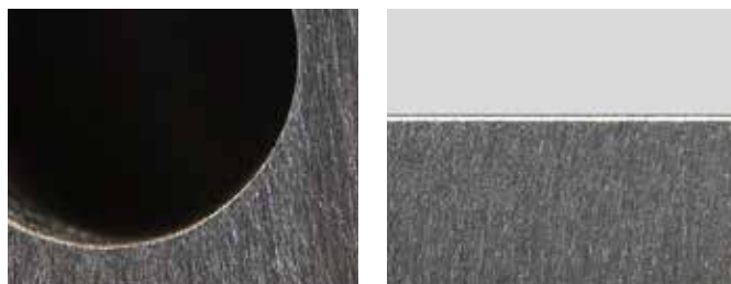
Dopo la lavorazione - Le bave sono state rimosse in modo affidabile e i bordi arrotondati. La superficie ha un aspetto uniforme e spazzolato.
