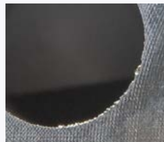
Przed obróbką - Wyraźne zadziory na krawędzi. Rowki frezarskie na powierzchni.
