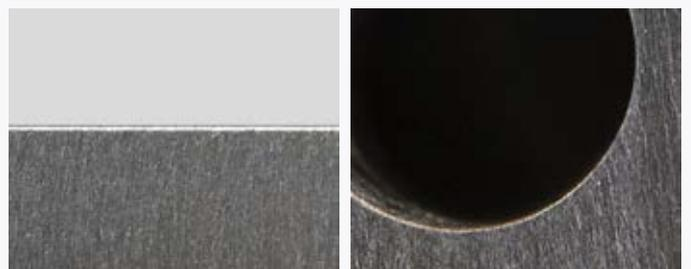
**Nach der Bearbeitung** - Die Grate wurden zuverlässig entfernt und die Kanten verrundet. Die Oberfläche hat ein gleichmäßiges, gebürstetes Aussehen.
