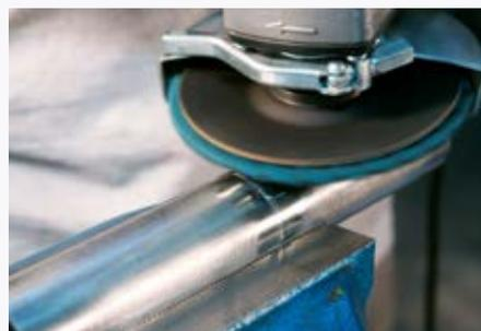
Schleifen feiner Schweißnähte und Entfernen thermischer Verfärbungen
