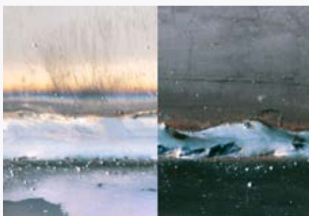
Les surfaces détartrées avant le soudage permettent d'obtenir des cordons de soudure propres (voir l'image de gauche).
