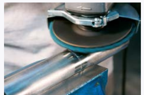
Poncer les joints de soudure fins et éliminer les décolorations thermiques
