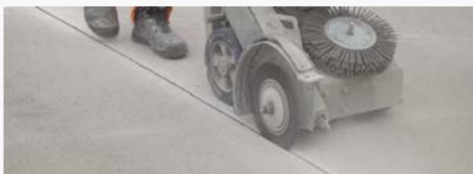
Escova para juntas utilizada na construção de estradas
