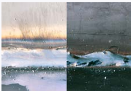
Curățarea suprafețelor înainte de sudare, au ca rezultat cordoane de sudură curate (vezi imaginea din stânga)
