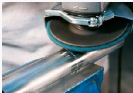
Șlefuirea cordoanelor fine de sudură și îndepărtarea decolorării termice
