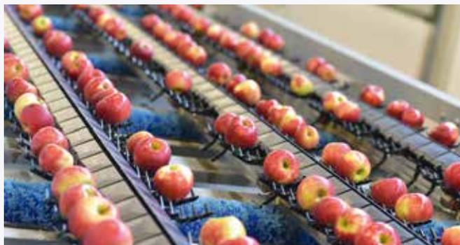
MultiZack®-Bürsten eignen sich zum Reinigen, Transportieren und Polieren von Obst und Gemüse.
