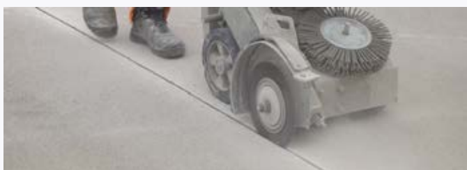
Szczotka do spoin stosowana w budownictwie drogowym
