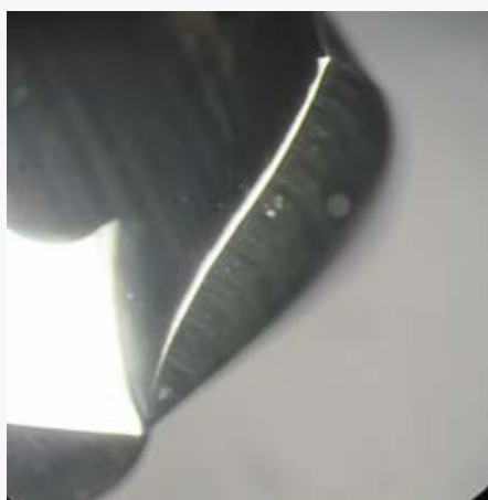
Prelucrat cu perie disc Ø150 SIC abraziv nailon grit 180
