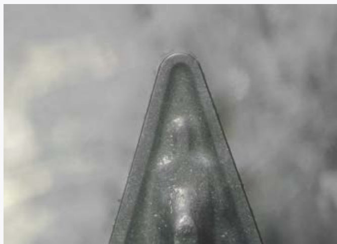
Inserție metalică din carbură, prelucrată
