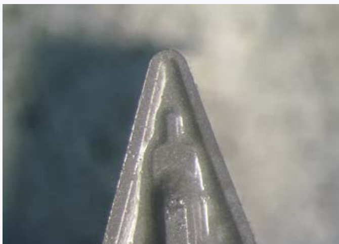
Inserție metalică din carbură, neprelucrată
