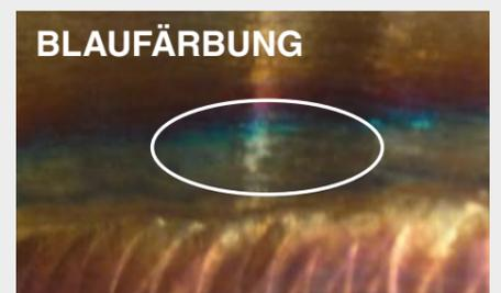
Nichtmetallische Einschlüsse haben eine verminderte Adhäsionsfähigkeit als das restliche Material der Schweißnaht. Wird das geschweißte Bauteil später mit einer Beschichtung versehen, kann es an den Einschluss-Stellen zu Beschichtungsfehlern und Korrosion kommen. Zu jedem Schweißverfahren und Art der zu bearbeitenden Naht (Wurzel, Füll- oder Decknähte) finden Sie in der Schweißmatrix das passende Reinigungs-werkzeug.
