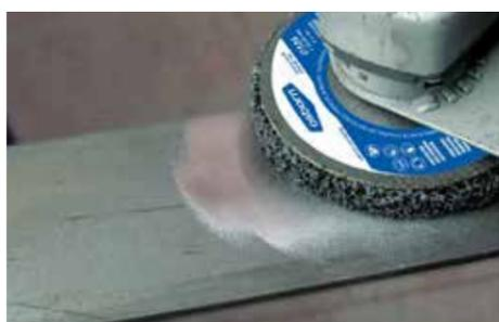
Reinigen/Entzundern einer Stahloberfläche mit dem Grobreinigungsvlies
