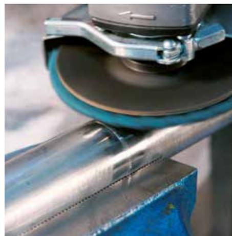
Nachbearbeitung einer Schweißnaht mit Polierfächerscheibe
