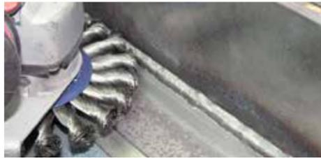
Schweißnahtreinigung mit Rundbürste gezoepft
