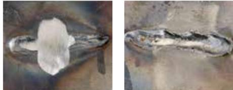
Bearbeitungsunterschiede: Links Bearbeitung mit einer Schruppscheibe (**spanabhebend**), rechts mit einer Bürste (**nicht spanabhebend**).
