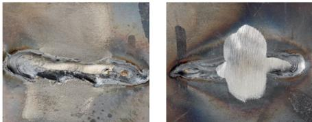
Nettoyage d'un cordon de soudure avec une brosse circulaire à mâches torsadées
