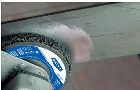
Nettoyage/débrassage d'une surface en acier avec le disque de gros nettoyage.
