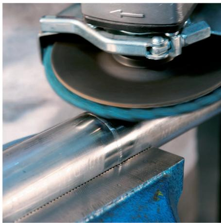
Reprise de cordon de soudure avec disque de polissage à lamelles.
