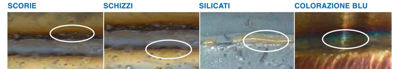
Contaminazioni più comuni che si verificano in un processo di saldatura.
