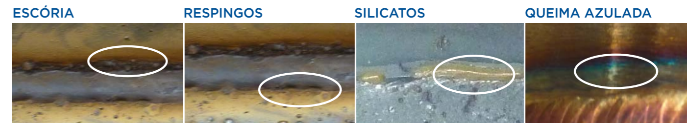
Tipos de contaminação mais comuns em um processo de solda.
